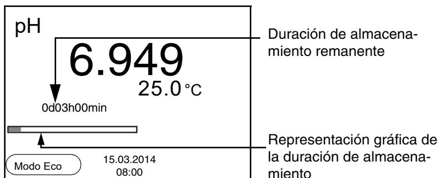
La actividad del almacenamiento automático se reconoce en la barra indicadora del progreso en el renglón de indicación del estado. La barra indicadora del progreso muestra la duración del almacenamiento remanente.
